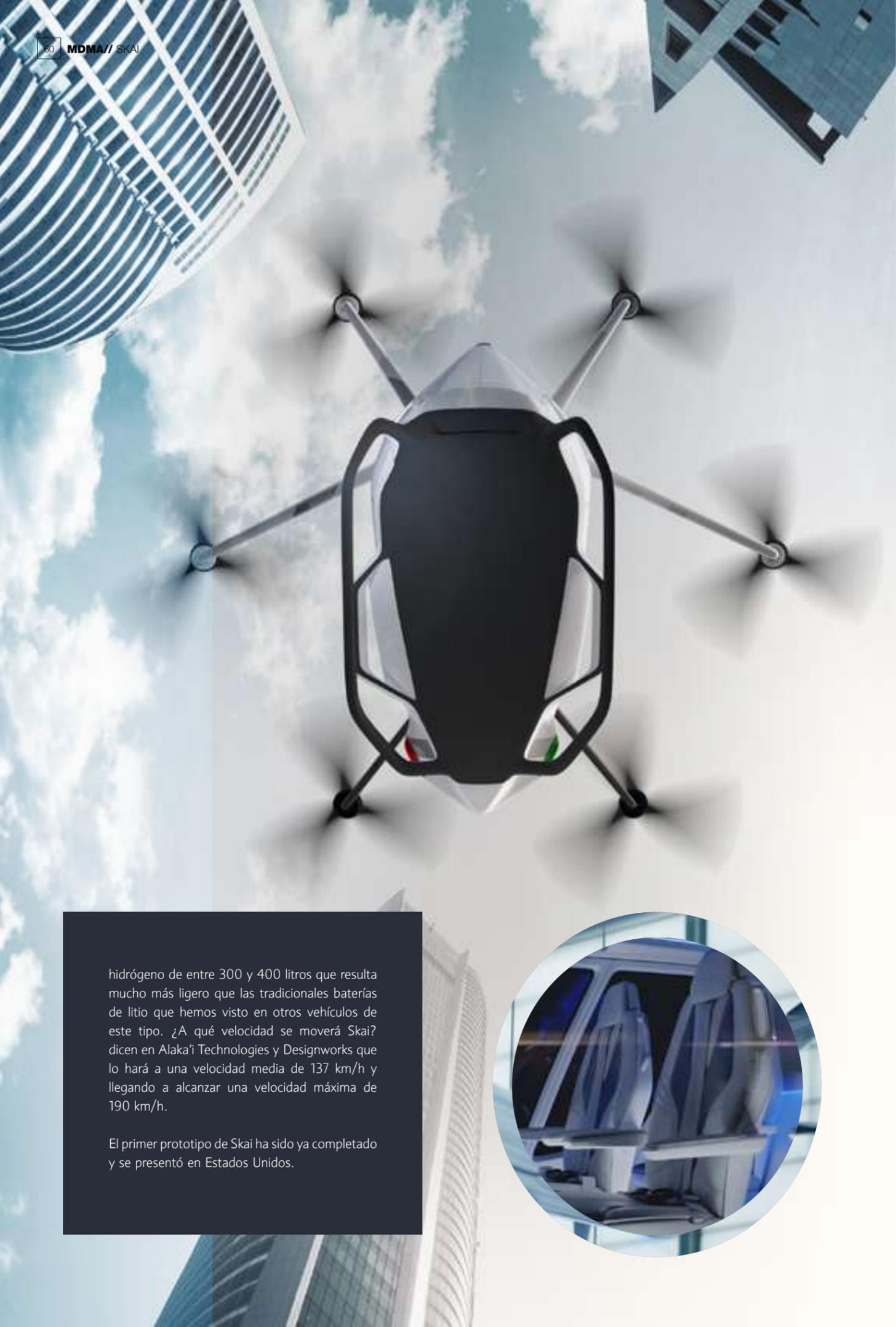
hidrógeno de entre 300 y 400 litros que resulta mucho más ligero que las tradicionales baterías de litio que hemos visto en otros vehículos de este tipo. ¿A qué velocidad se moverá Skai? dicen en Alaka'i Technologies y Designworks que lo hará a una velocidad media de 137 km/h y llegando a alcanzar una velocidad máxima de 190 km/h.
